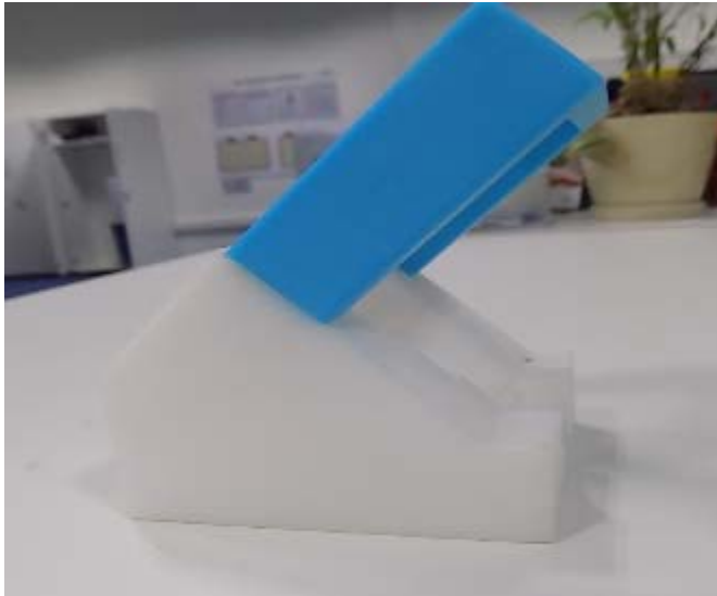
Fig.8: Keyway Açılı Ölçüm Kalıbı
