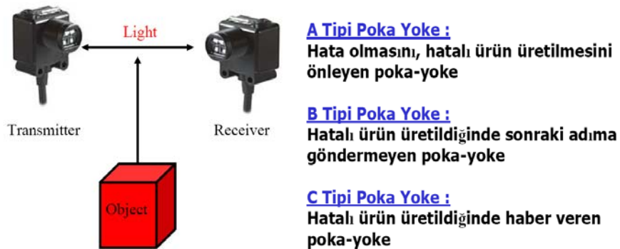
Şekil 9: Poka Yoke Yöntemleri ve Bir Poka Yoke Örneği
