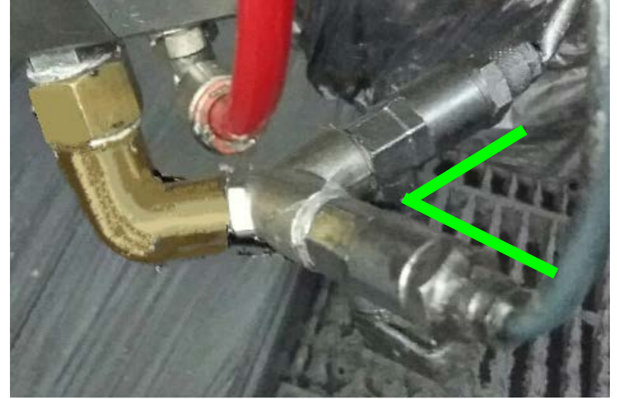
SONRA: Tabanca girişi çiftli bağlantı
