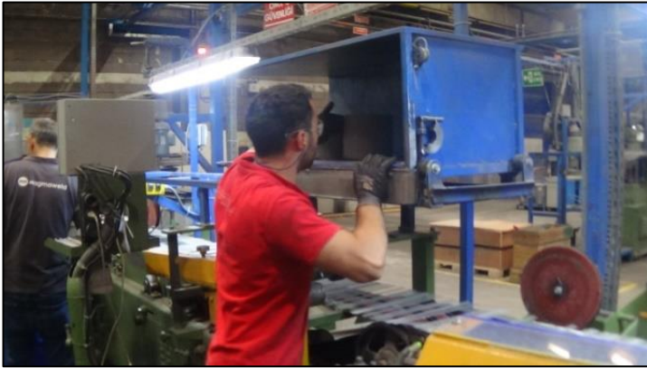
Resim 5. Briketin manual taşıma arabasından alınması
