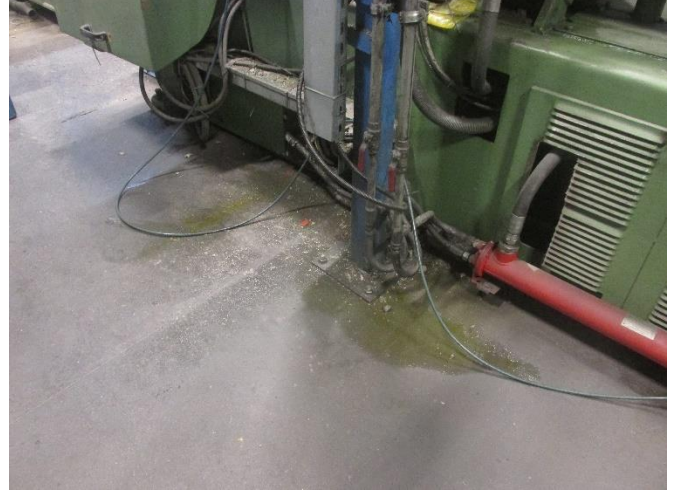
Resim 3-4: Manuel yağlamadan dolayı ortaya çıkan kir kaynakları
