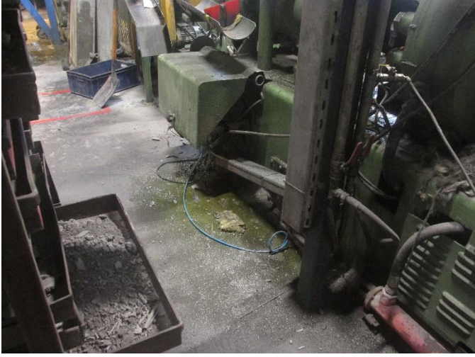
Resim 3-4: Manuel yağlamadan dolayı ortaya çıkan kir kaynakları
