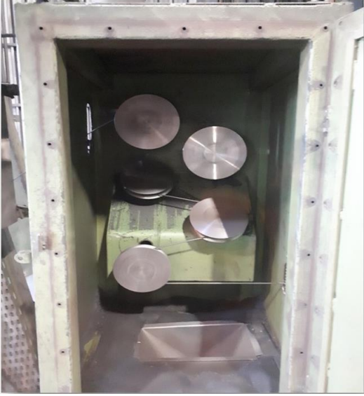
Resim 2: Dış çapı arttırılmış makaralar
