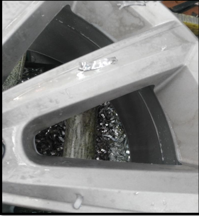
Resim 2. Jant Yüzeyinde Talaş Ve Boryağı
